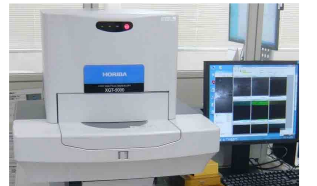
【図1】エックス線分析顕微鏡 XGT (蛍光エックス線により化学分析を行う装置) 1mm以下のスケールで試料表面の元素の分布を知ることができます
